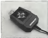
Figura 2 - Il tastierino del computer del PDP-10. Il DT 100. Premendo i tasti Z 1 2 3 vengono trasmessi rispettivamente i valori 1 2 4 8 in codice su un/byte.
